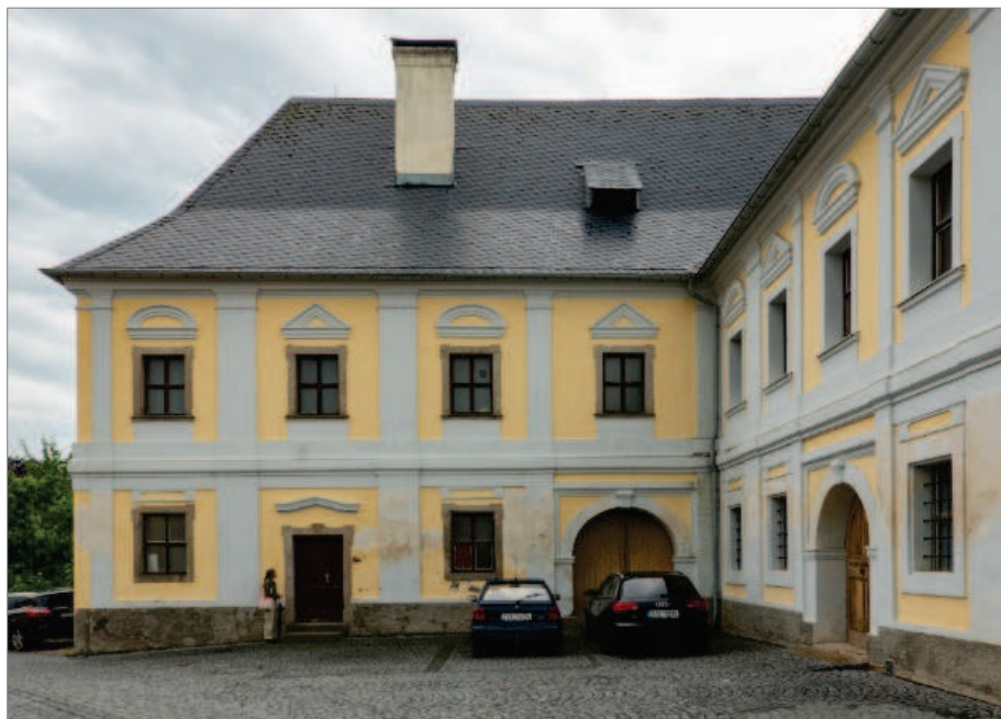
Obr. 3-63: Severní strana přístavby fary z roku 1737 s dveřními a okenními zárubněmi ze žuly. / Nordfassade des 1737 errichteten Anbaus des Pfarrhofs mit Tür- und Fenstergewänden aus Granit.
