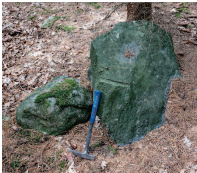
Obr. 10-9: Žulový blok se stopou po vrtu, což svědčí o dělení původně větších bloků v bývalé kupě v lese jižně od Dolní Jadruže. / Granitblock mit Bohrspur die auf ein Teilen eines ursprünglich größeren Blocks einer ehemaligen Blockhalde im Wald südlich Dolní Jadruž hindeutet.
