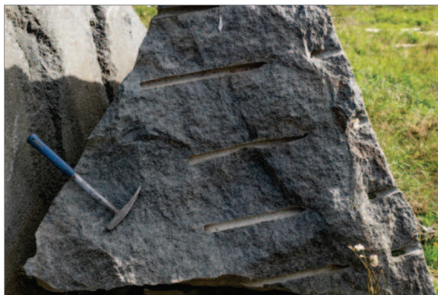
Obr. 10-19: Blok s řadou vrtů, které byly používány při šetrném odstřelu velmi pevných kamenů. / Block mit einer Reihe von Bohrlöchern, die zum Teilen der sehr festen Werksteinblöcke mittels schonender Sprengungen genutzt wurden.
