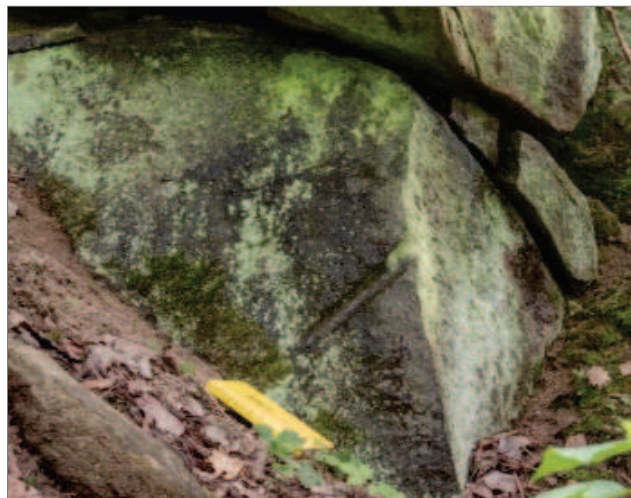
Obr. 10-13: Asi 20 cm dlouhá stopa po vrtu na jednom z největších bloků v lomu. / Ca. 20 cm lange Bohrspur an einem der massigen Blöcke im Steinbruch.
