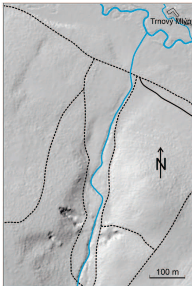
Obr. 10-14: Ve stínovaném režimu digitálního modelu terénu lze v lese velmi dobře rozeznat stopy po dolování. Datový zdroj: Geoportál ČÚZK. / Im Schummerungsmodus des Digitalen Geländemodells sind die Abbauspuren im Wald ausgezeichnet zu erkennen. Datenbasis: Geoportal der Tschechischen Republik.
